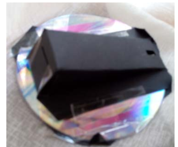
5. ábra. CD- vagy DVD-lemezből és ányékoló kartonlappból készített rácsspektroszkóp.
