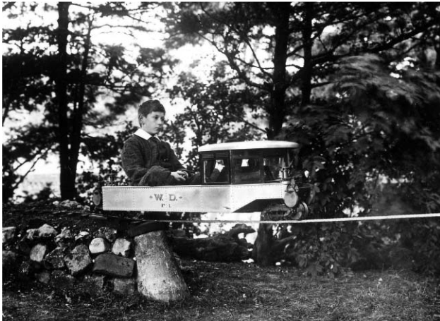
14. ábra. Brennan drótkötélen mozgó, pörgettyűvel stabilizált járműmodellje (1905).
