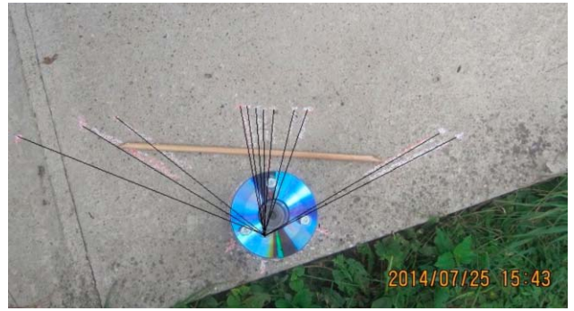
7. ábra. CD-ből készült gnomon a július 25-i méréskor.
