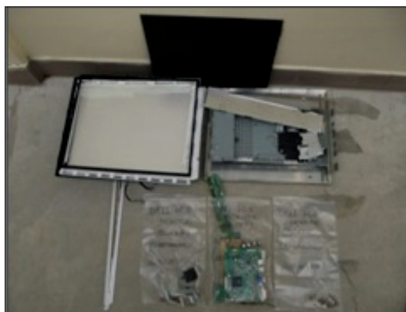
LCD panel szétszedett állapotban, az egyes rétegek feldolgozásra előkészített anyagával
