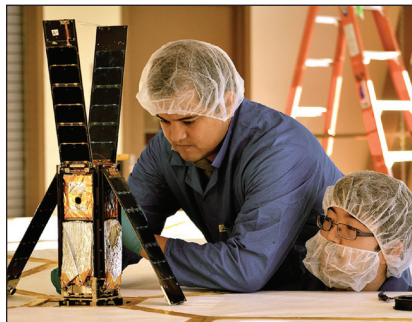
7. ábra. A LightSail űrszonda majdnem teljesen összecsomagolt állapotában
