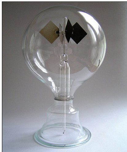
1. ábra. Crookes-féle radiométer
