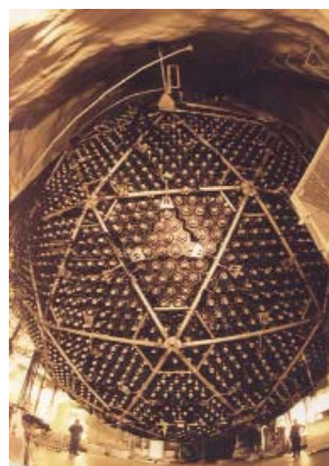
3. ábra. Az SNO nehézvízes neutrínódetektorának víztartálya, az oldalán látható „mintázatot” a Cserenkov-sugárzást észlelő detektorok kivezetései alkotják
