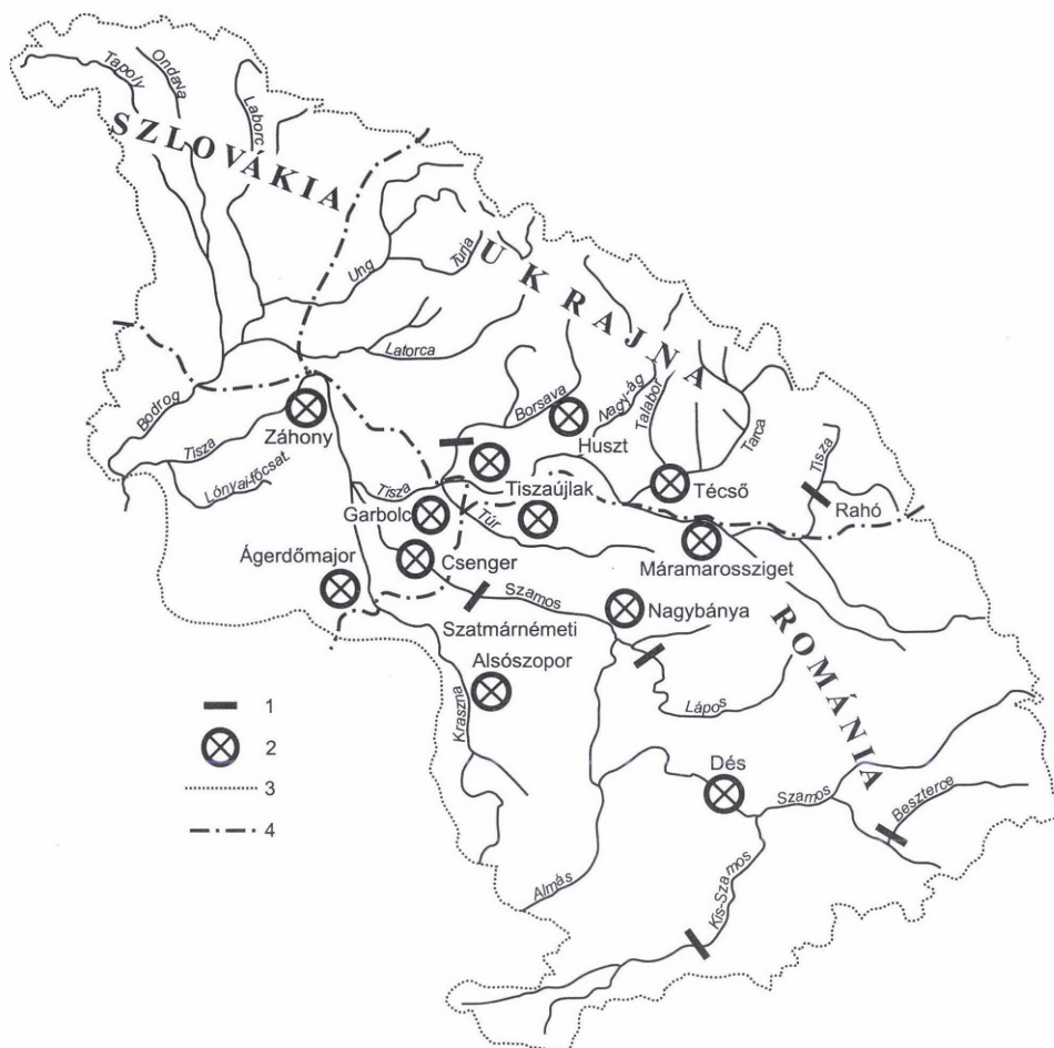
1. ábra. Automatikus monitoring-hálózat a Felső-Tisza vízgyűjtőjén (szerk.: GERGELY K. 2004). – 1 = vízminőségi törzshálózati mintavételi állomás; 2 = automatikus mérőállomás; 3 = országhatár; 4 = a vizsgált terület határa
