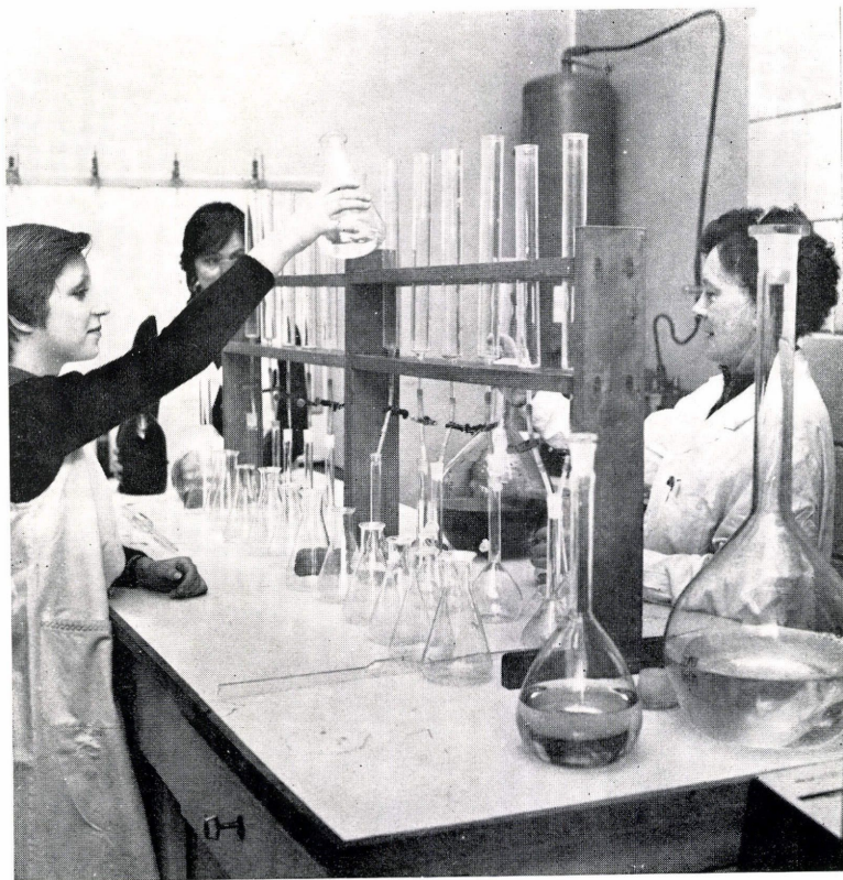
22. kép. Kicszerelhető kation meghatározás az Intézet Talajlaboratóriumában (MÉSZÁROS E., DI GLÉRIA M., SZEBÉNYI L.-NÉ). Fotó: POÓR I. Determination of exchangeable cation at the Soil Laboratory of the institute (E. MÉSZÁROS, M. DI GLÉRIA, MRS. L. SZEBÉNYI). Photo: I. POÓR
