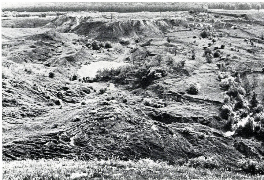
4. kép. Külszíni és mélyművelésű bányászattal megbontott domborzat eszamlásokkal és rogyásokkal Ebszönybányán Relief détruit par l'exploitation minière à ciel ouvert et à labour profond avec des glissements de terrain et des affaissements à Ebszönybánya
