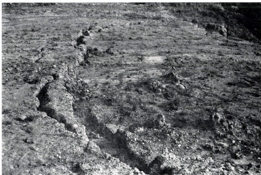
2. kép. Építkezésre előkészített antropogén feltöltések rogyásos, csuszamlásos felszíne Surface d'affaissement et de glissement des remblais anthropiques préparés pour les travaux de construction
