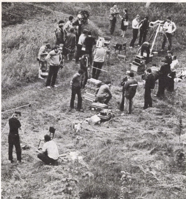
1. kép. Sugárzásmérők kalibrálása a kísérleti állomáson
