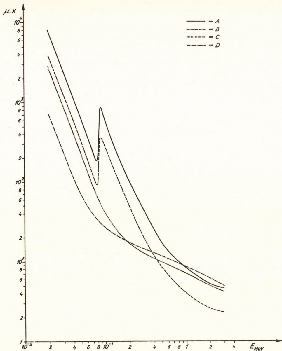
7. ábra. Különböző átvékő falak totális abszorpció képessége \gamma -sugárzásra vonatkozóan, az energia függvényében. A 10 cm Pb, B 5 cm Pb, C 15 cm Fe, D 50 cm \text{CaCO}_3 .
