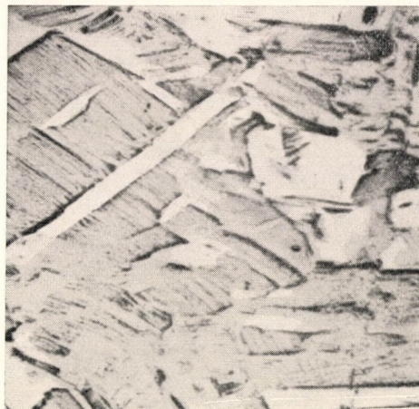
Bild 5. Gefüge eines austenitischen Chromnickelstahles nach einer 20%igen Kaltverformung, untersucht mit der Suspensionsmethode (150fache Vergrößerung)
