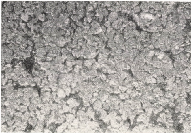
Bild 7. Wie im Bild 6, aber das Probestück wurde bei 850 °C 10 Min. lang gesintert. Vergrößerung: 150×
