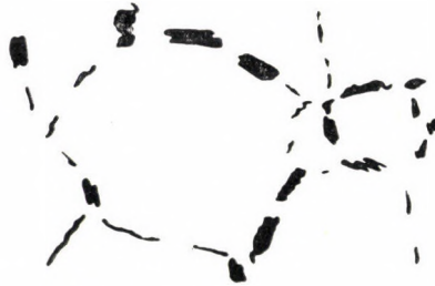
Bild 10. Im Rekristallisationsprozeß von 0,1% Zinn enthaltenden Kadmiumpüttchen umsiedeln die unlöslichen, Sn-haltigen Teilchen von ihren früheren Plätzen auf die neuen Korngrenzen. Diese von TAMMANN stammende Skizze zeigt die Neuordnung der Teilchen nach einem Erhitzen auf 250 °C
