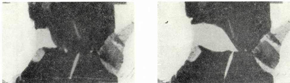
Bild 9. In einer, mit einem Stich von 15% durch Druck deformierten Zinkscheibe aus reinem gegossenem Zink erscheint und wächst ein neuer Kristall während der Rekristallisation bei 110 °C (heller Kristall in der Bildmitte). Mit polarisiertem Licht aufgenommenes Bild; Vergrößerung etwa 140×
