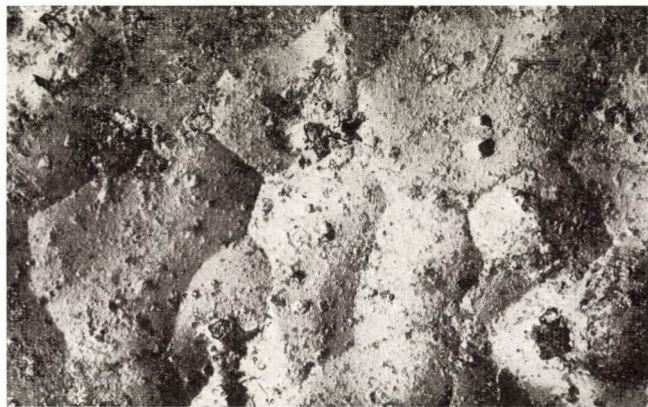
Bild 2. Oberfläche eines GK-Wolframstabes (K, Si, Al Zusätze) nicht vollständig gesintert. Elektronenoptisch 1700fach vergrößert. Die Kristallitgrenzen fehlen an mehreren Stellen, und so entstanden größere Kristalle
