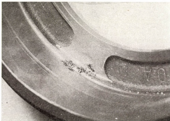
Bild 1. Kennzeichnende Gestalt der interdendritischen Porosität in Graugußstücken
