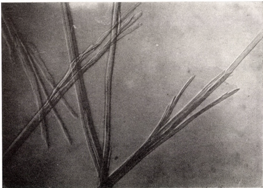
Abb. 3b. Spalten der Filamente in Fibrillenbündel bei der Dauerprüfung des Viskosekordes 1650/2, 480/480. (Zugbelastung: 1000 g, Biegerollendurchmesser: 9,5 mm, Temperatur: 80° C)
