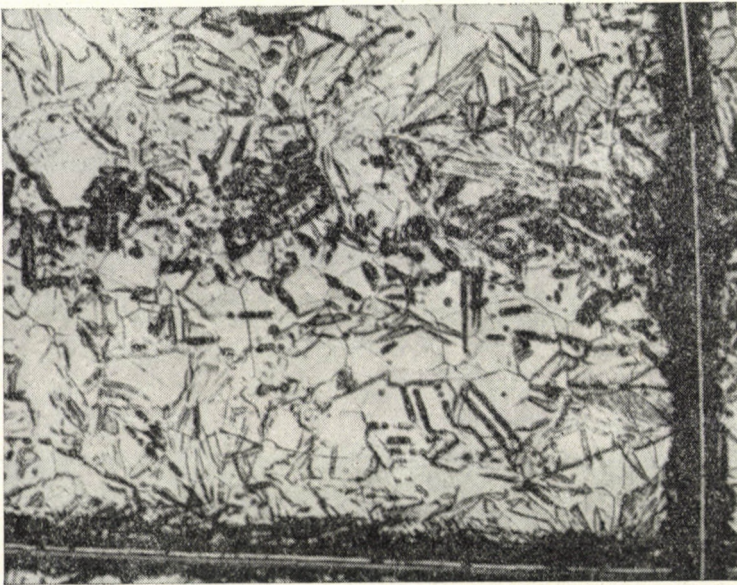
Bild 8. Gefügebild der Schliﬀprobe nach dem Glühen 1 Stunde lang bei 1000° C Glühtemperatur (Vergr. 200×)
