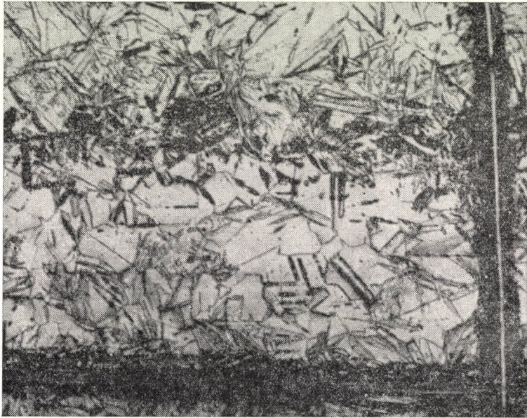
Bild 7. Ausgangsgefüge vor dem Glühen (Vergr. 200 \times ). Entspricht gleichzeitig dem Gefügebild nach der Erwärmung bei 850° C
