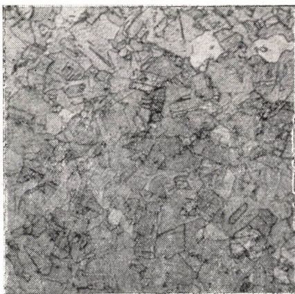
Abb. 23. Gefüge der bei 700° C um 40% gestauchten Probe. Praktisch vollständig homogene Körner; feineres Gefüge. 50×
