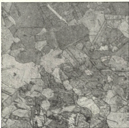
Abb. 21. Gefüge der bei 700° C um 14% gestauchten Probe. Heterogenität der Korngröße weiter verringert. 50×
