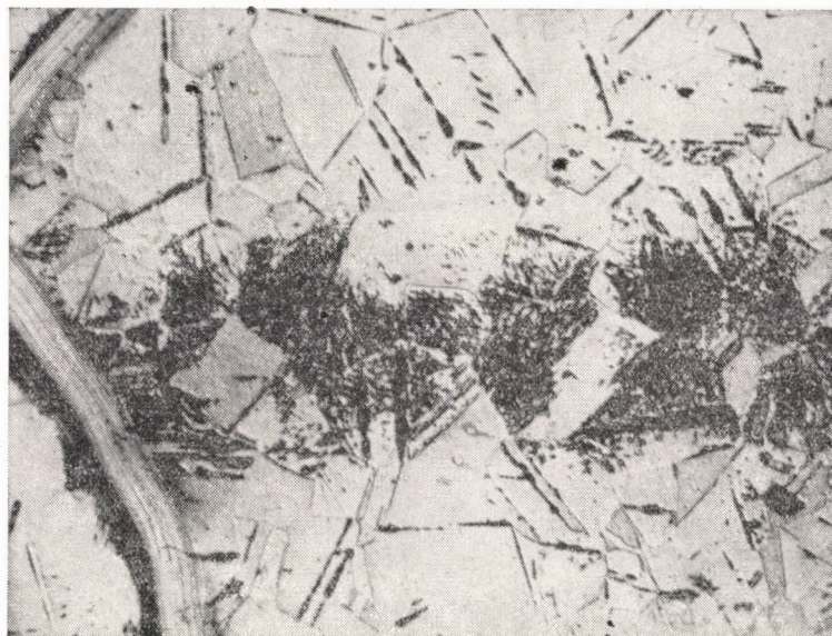
Bild 4. Ausgangsgefüge vor dem Abkühlen (Vergr. 200\times )
