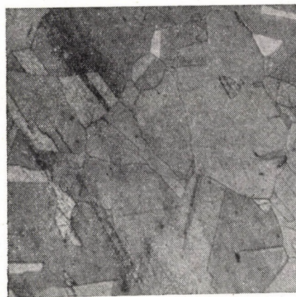
Abb. 24. Gefüge des bei 920° C 12' lang erhitzten und ohne Verformung in Wasser abgeschreckten Zustandes (M9). 50×
