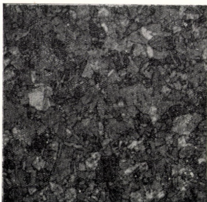
Abb. 13. Ausgangsgefüge des Versuchswerkstoffes ( \varnothing = 0,05 mm) 75 \times
