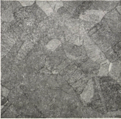
Abb. 25. Gefüge der bei 900° C um 5% gestauchten Probe. Änderung der Korn- größe bereits sichtbar. 50×
