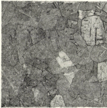
Abb. 27. Gefüge der bei 900° C um 40% gestauchten Probe. Noch gleich- mäßigeres Korn. 50×
