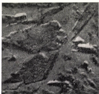
Bild 1. Partikeln des Oberflächenmartensits
