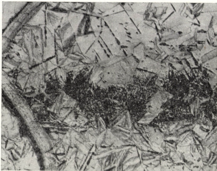
Bild 5. Gefügebild nach Unterkühlung bei -78^{\circ} C (Vergr. 200\times )
