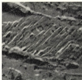
Bild 5. Längliche Oberflächenmartensitpartikeln zwischen zwei normalen Martensitplättchen
