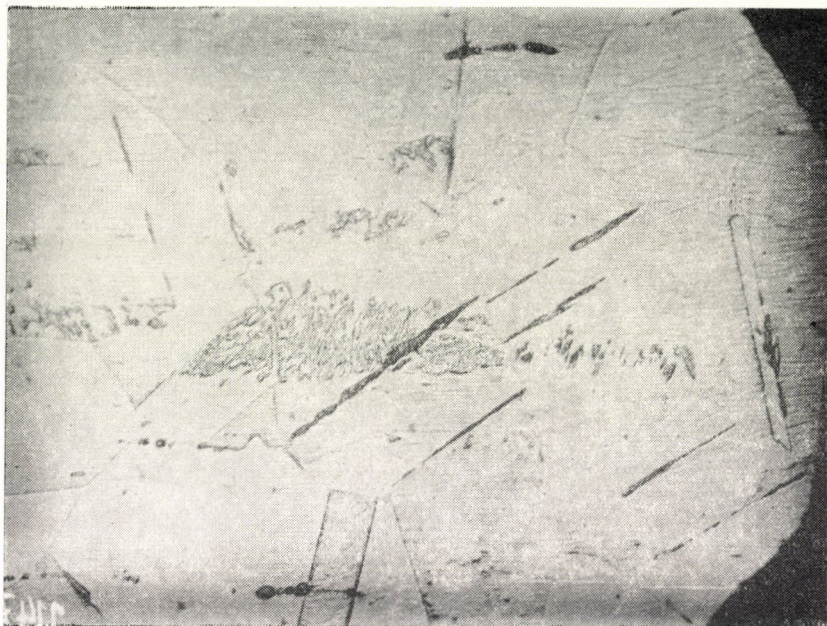
Bild 4. Beispiel der Unabhängigkeit des Oberflächenmartensits von normalen martensitischen Nadeln (500×)
