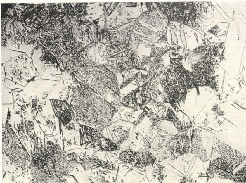
Bild 7. Oberflächenmartensit im Austenit (200×)
