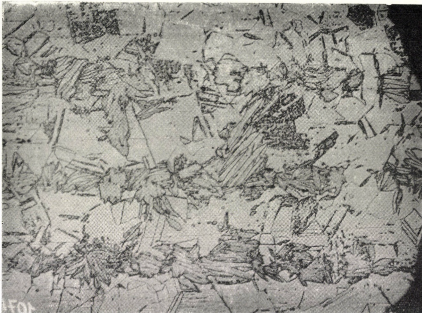
Bild 9. Zeilen des normalen nadeligen Martensits mit Oberflächenmartensit (300×)
