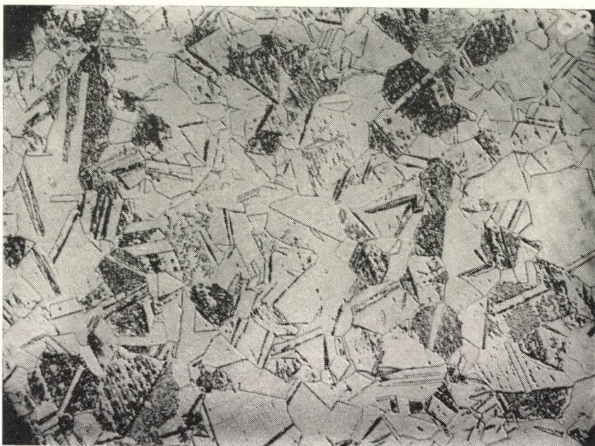
Bild 5. Die Abhängigkeit des Oberflächenmartensits von der Zwillingsbildung der austenitischen Kristallite. Seine Ausbildung in Zeilen (200 \times )
