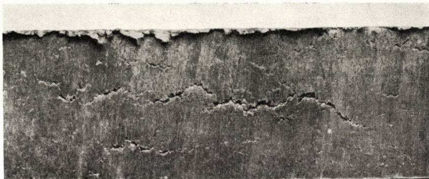
Рис. 2. Поперечные трещины по середине листа альп. 62
