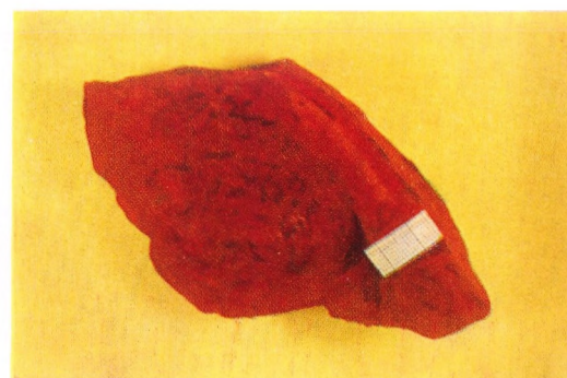
Photo 8. Bauxite primaire oxydative (Ma Meo) à oxydation secondaire
