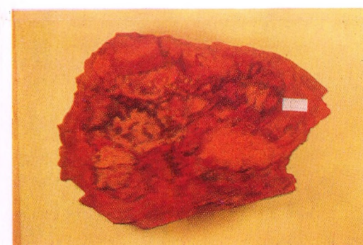
Photo 9. Détritux oxydatifs primaires dans la bauxite primaire réductive (Tam Lung)
