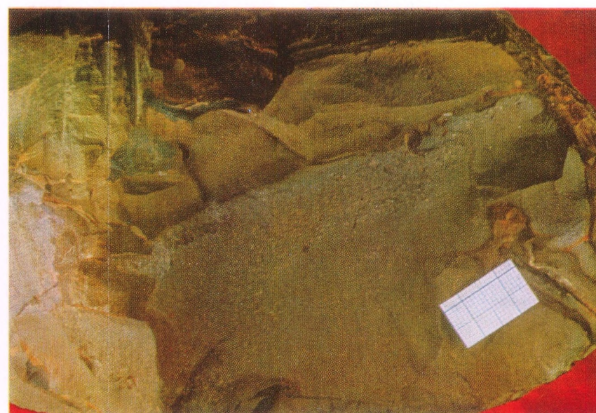
Photo 10. Argilite (Ban Long), au milieu: strie de bauxite, au bord: oxydation secondaire
