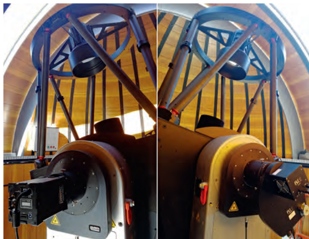
Kamerák a teleszkóp Nasmyth-fókuszaiban: a holdi becsapódások rögzítésére szolgáló Photometrics Prime 95B kamera (bal oldal) és a fotometriai megfigyelésekre szolgáló FLI CCD-kamera (jobb oldal)
