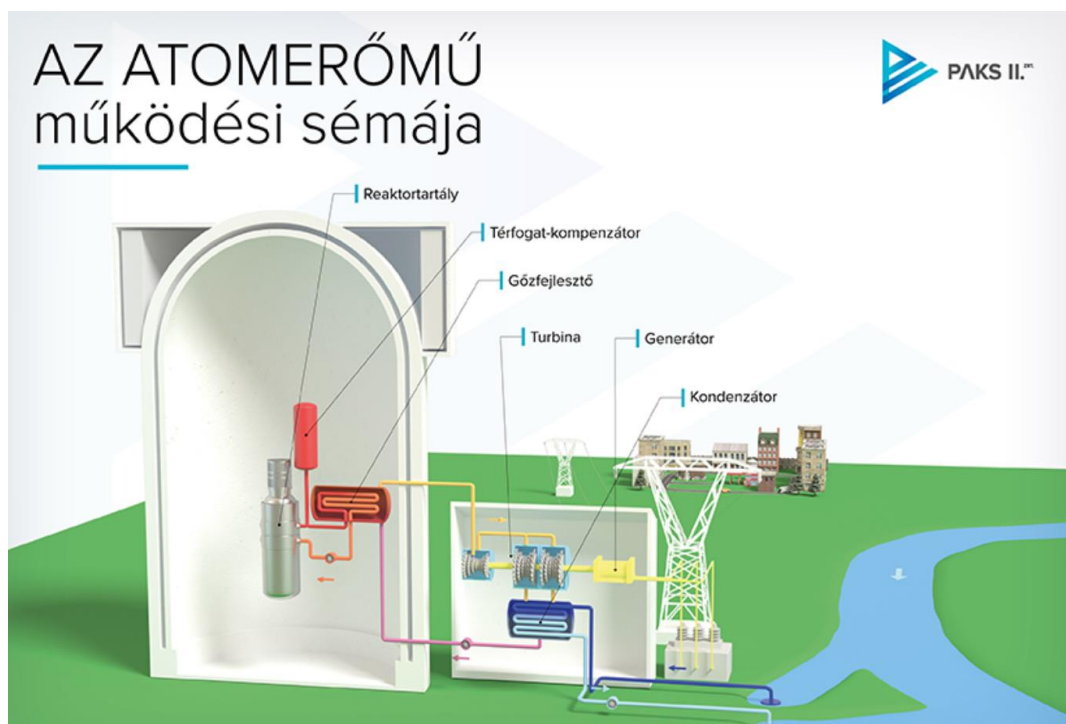
4. ábra Paks 2 atomerőmű működési séma
