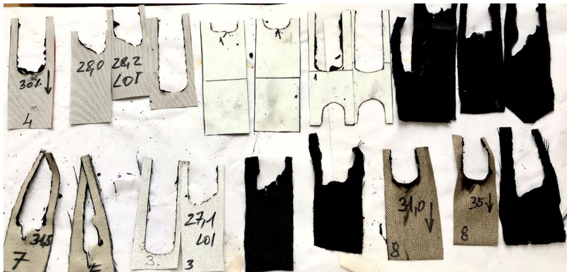
4. kép: Minták Oxigén index mérése utáni állapotban. készítette: A szerző.
