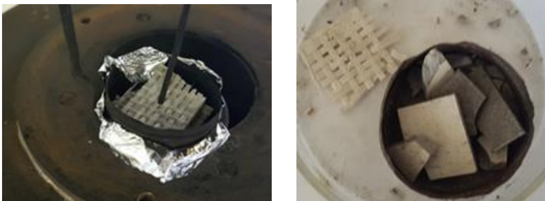
12. kép: „B” minta állapota kemencében való felfűtés előtt és utáni állapotban. Az üvegszálás háló leválása jól látható, de drasztikus elszenesedés nincs. Készítette: A szerző.
