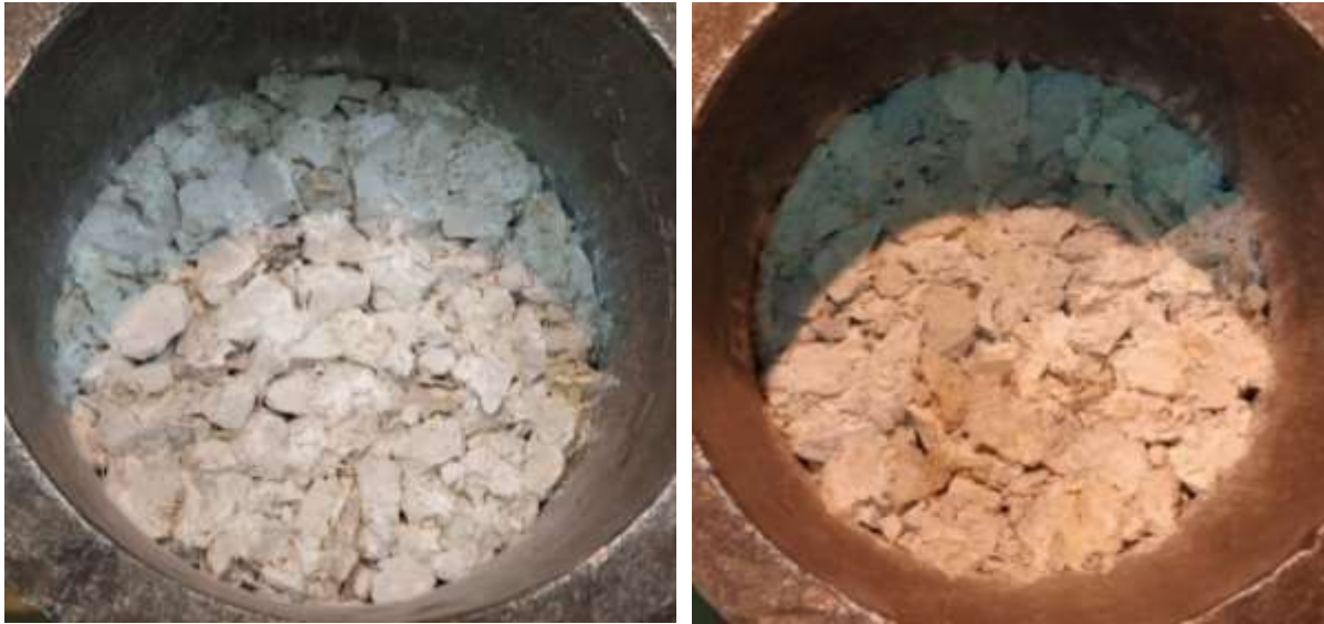
10. ábra: Hummel mozsárban megzúzott referencia (20 °C) (bal) és 800 °C-on hőterhelt (jobb) mészkő minták
