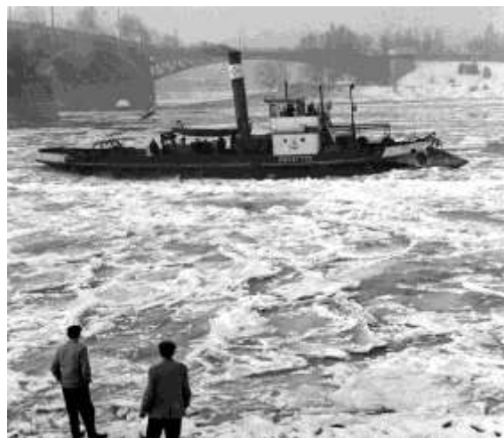
3. ábra: Jégtörő papuccsal felszerelt Berettyó gőzös a Szent István rakpart előtt 6
