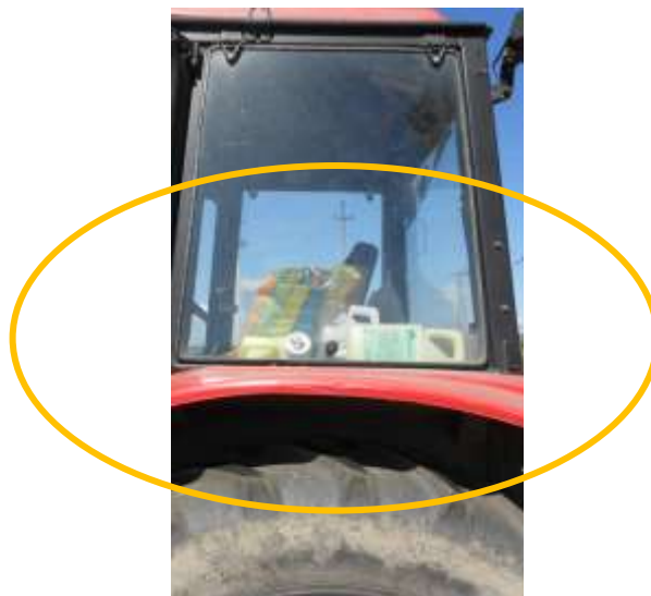
2. fénykép. A vezető munkaterében szabálytalanul elhelyezett növényvédő szerek.
