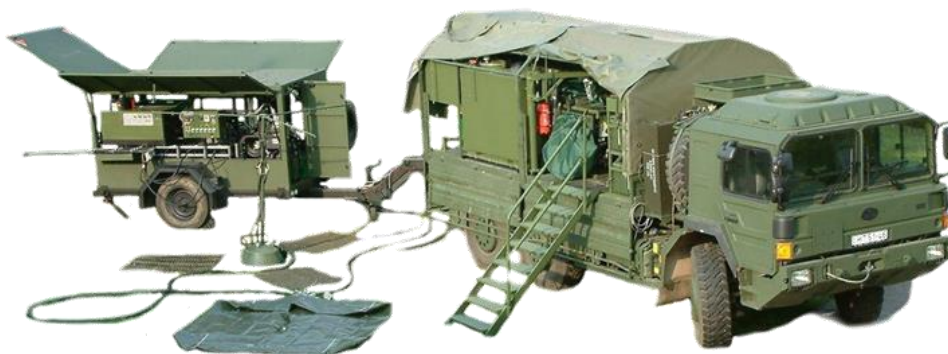
6. sz. fotó ABV mentesítő berendezés /utánfutóval/ (forrás: MH 93. PS VV-i Zászlóalj)
