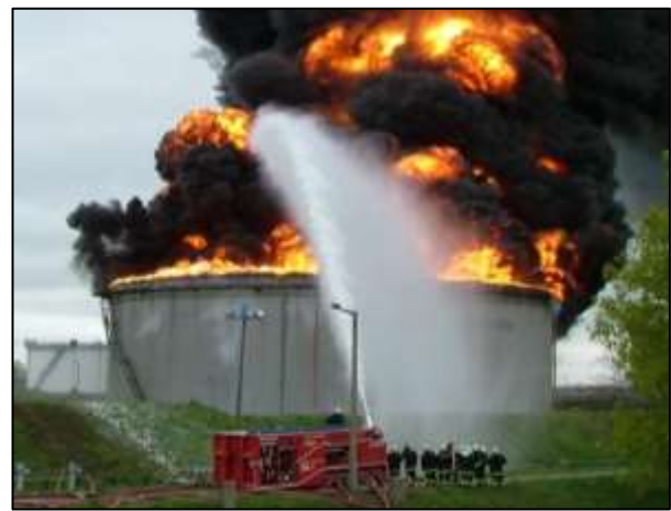
6. fénykép: Silvani MP 20000 mobil oltóközpont tűzoltás közben
