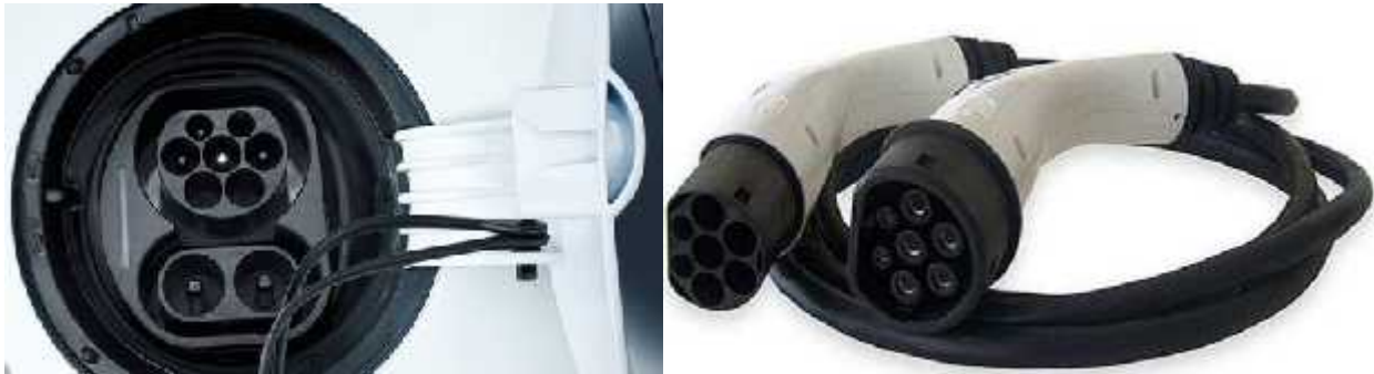
8.ábra 8 : Volkswagen e-UP töltője, 9.ábra 9 : TYPE2 töltőkábel
