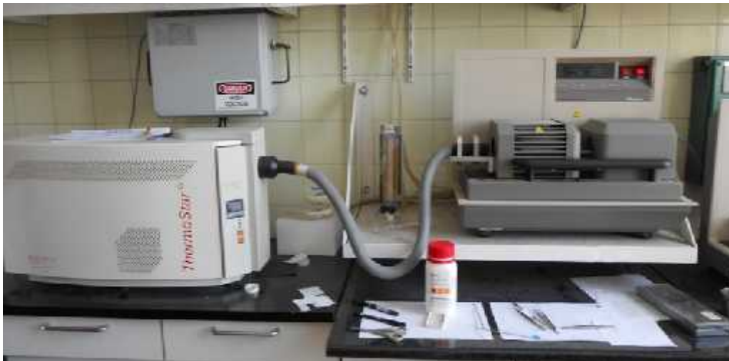
2. ábra: A TA Instruments SDT 2960 típusú szimultán TG/DTA készülék és a hozzá on-line kapcsolt Balzers Instruments Thermostar GSD 300T tömegspektrométer
