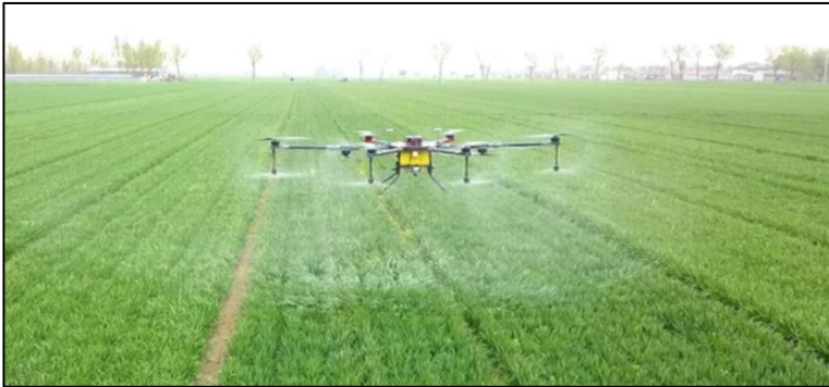
3. ábra. Drón felületpermetezés közben
