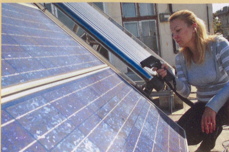
Napelemek hőmérsékletleadásának mérése a Szent István Egyetem Fizika és Folyamatirányítási Tanszékén
