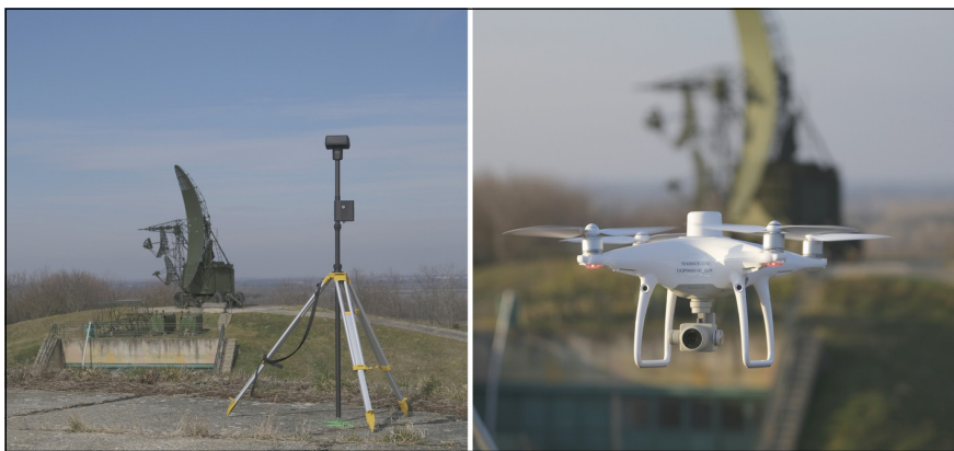
7. ábra. A DJI Phantom 4 RTK-rendszer: drón és RTK-bázis
