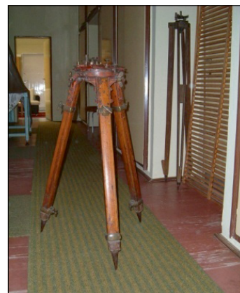
3. ábra. Cséti-féle bányászati műszerállvány
