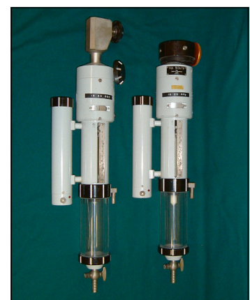
25. ábra. A Miskolci hidrosztatikai szintező
