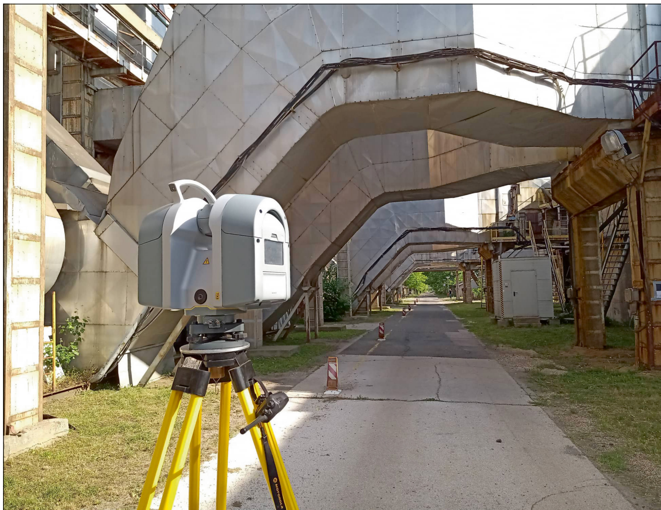
A felállított műszer egy erőmű szkennelése közben
