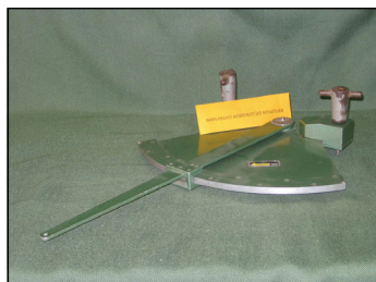
18. ábra. Bányászati körívkitűző készülék
