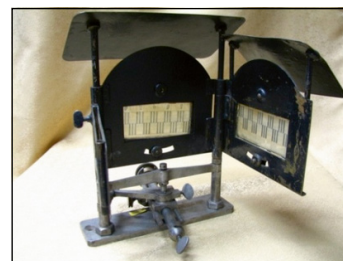
5. ábra. Cséti-féle lengésmegfigyelő készülék
