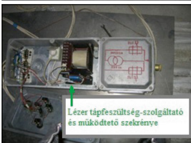
27. ábra. Képek a kifejlesztett lézeres irányadóról
