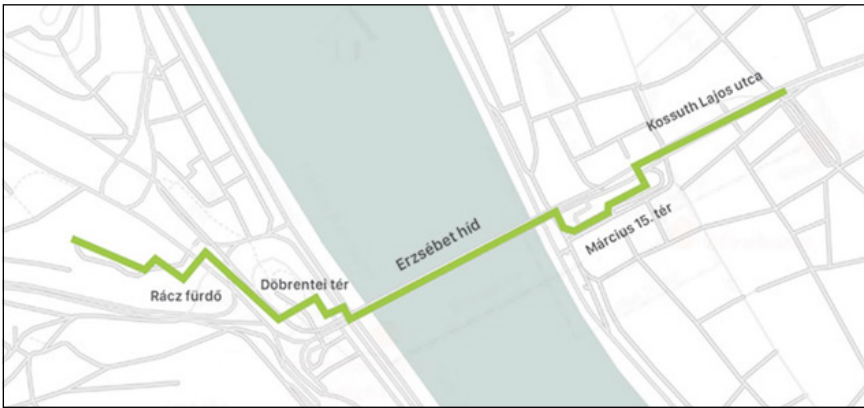
3. ábra. A tervezett távhővezeték nyomvonal (KAFSZTER 2019)
