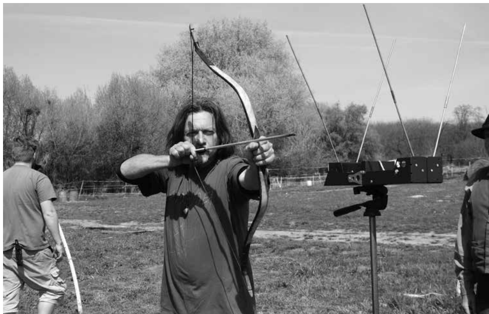
2. kép: A nyíl kezdősebességének mérése célzott lövés közben (fotó: Kőmíves Nelli)
