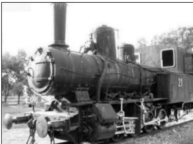
6. kép. A bányatársulat 1000 mm nyomtávú, B. Demmer rendszerű, a floridsdorfi gépgyárban készült erősebb gőzmozdonya 26
