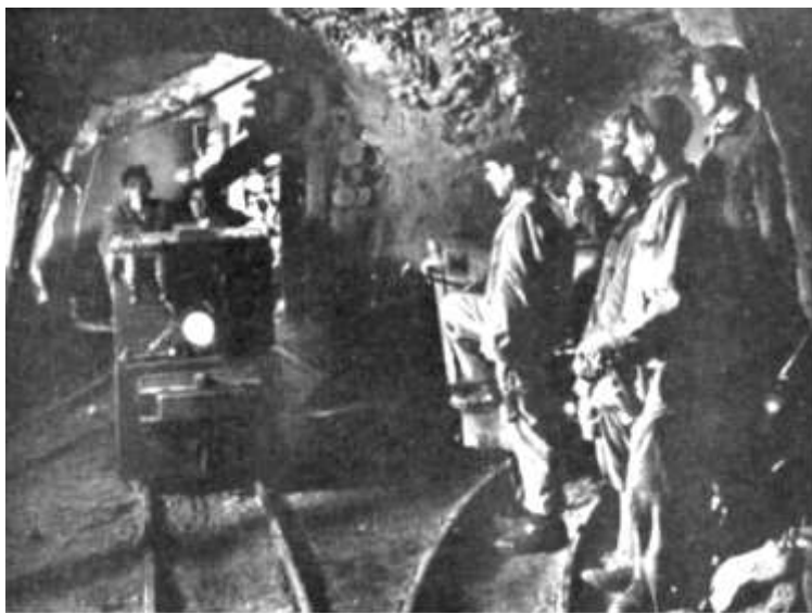
17. kép. LEW-EL-9 akkumulátoros mozdony kamrafejtésben 30
