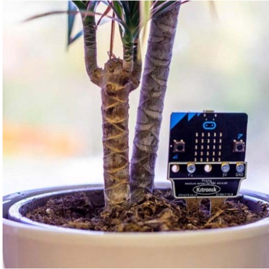
7. ábra: Virágföldek nedvességtartalmának mérése
