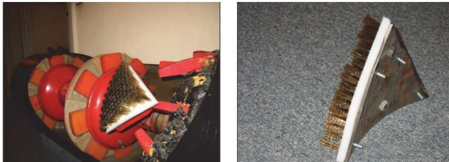
3. ábra. FBCT (Full Bore Cleaning Tool), a Challenger SOS fejlesztése
