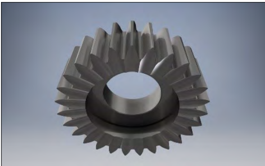
10. ábra. Metszőkerék 3D-modellje
