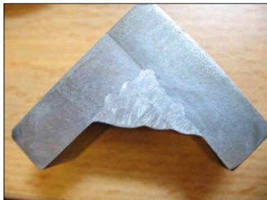
3. ábra. Hegesztett varrat polírozva és maratva
