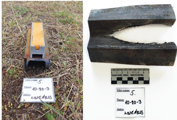
9. ábra: Az 5. töltet a céltárgyon és a vágás eredménye Forrás: a szerző felvétele
