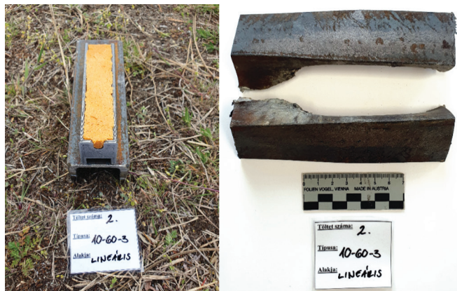
6. ábra: A 2. töltet a céltárgyon és a vágás eredménye Forrás: a szerző felvétele
