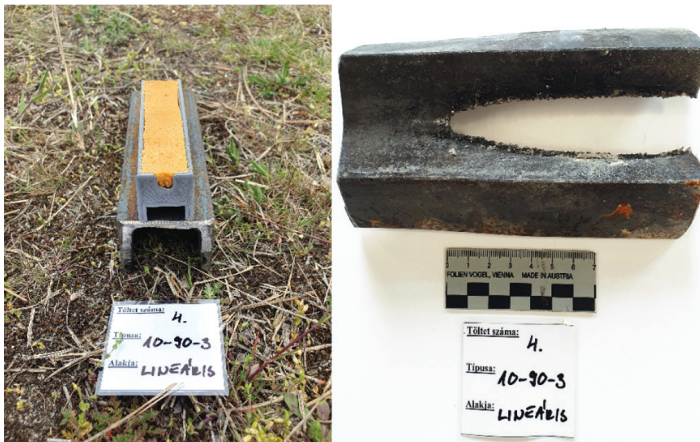
8. ábra: A 4. töltet a céltárgyon és a vágás eredménye Forrás: a szerző felvétele
