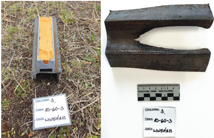
7. ábra: A 3. töltet a céltárgyon és a vágás eredménye Forrás: a szerző felvétele
