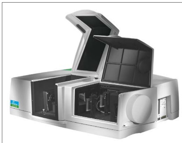
1. kép: A méréseket PerkinElmer Lambda 1050 UV/Vis/NIR spektrofotométer segítségével végeztük el. ( https://resources.perkinelmer.com/lab-solutions/resources/images_for_resize/Lambda_1050_Silo.png )
