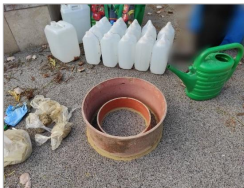
2.b. ábra. Dupla gyűrűs beszivárgás mérés Figure 2.b. Double ring method
