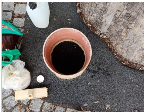
2.a. ábra. Szimpla gyűrűs beszivárgás mérés Figure 2.a. Single ring method
