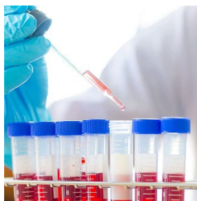
Bild 2: Material zur Probenahme der Niederschlagsproben. Zentrifugenröhrchen (Polypropylen, 15 mL Nennvolumen) mit Schraubdeckel (Polypropylen)
