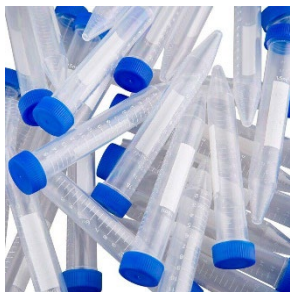
Bild 2: Material zur Probenahme der Niederschlagsproben. Zentrifugenröhrchen (Polypropylen, 15 mL Nennvolumen) mit Schraubdeckel (Polypropylen)
