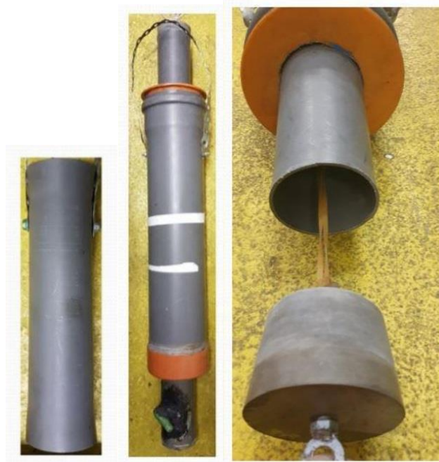
2. ábra Mélységi vízmintavevő (forrás: saját fotó) Figure 2. Deep water sampler (source: own picture)
