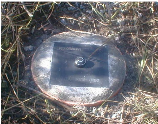
2. ábra. Univerzális pontjelölés szintezés, GPS és gravimetriai mérések végrehajtásához.
