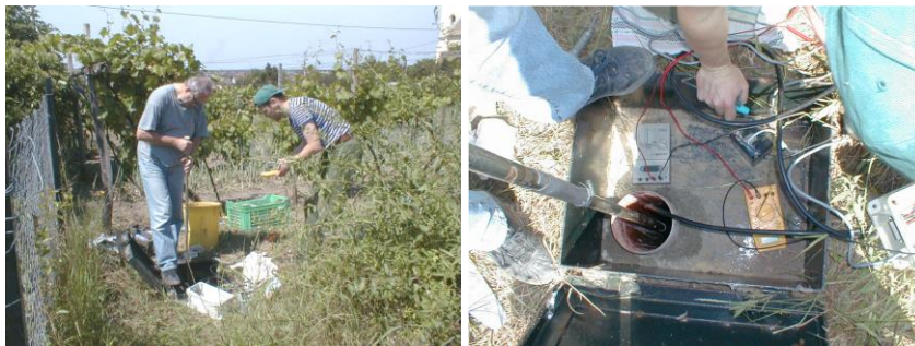
6. ábra. A dőlésmérő rögzítése a fúrólyukban.
