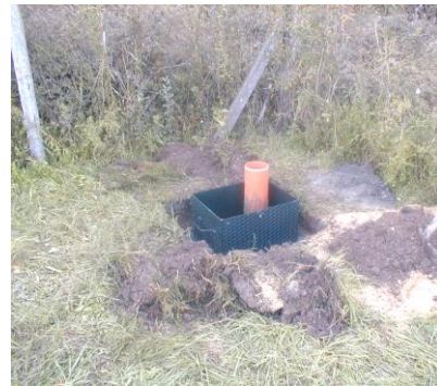
5. ábra. A fúróluk felső része az acélládaival.
