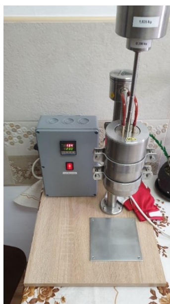
3. ábra. A megvalósított kapilláris plasztométer
