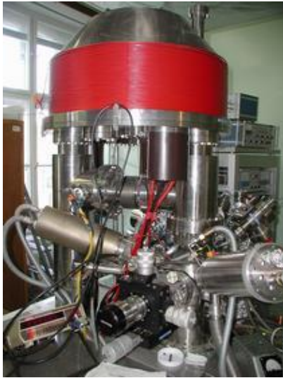
Az anyagtudományokat szolgáló ESA-31 elektron spektrométer
