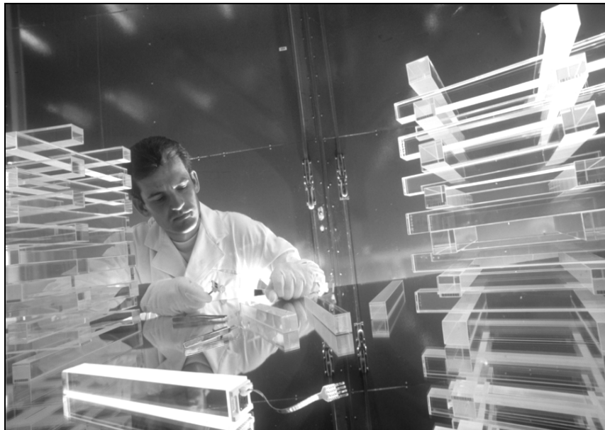
4. ábra: PbWO_4 egykristály szcintillátorok előkészítése a CMS-detektor elektromágneses kalorimétere számára.
