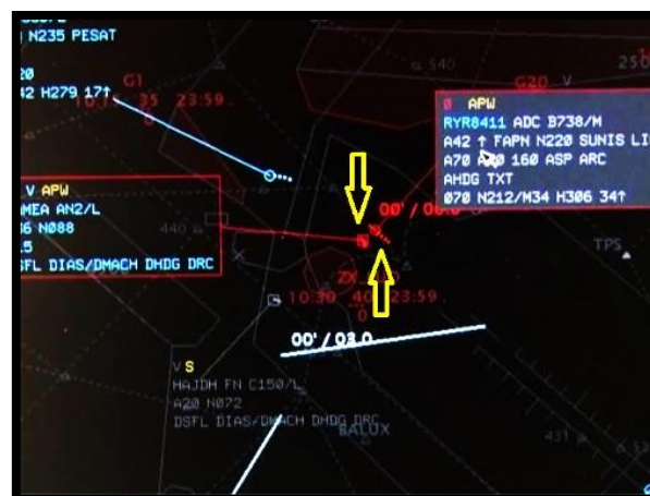
9. ábra: Radarindikátoron megjelenő repülőgép transzponder adatok 41
