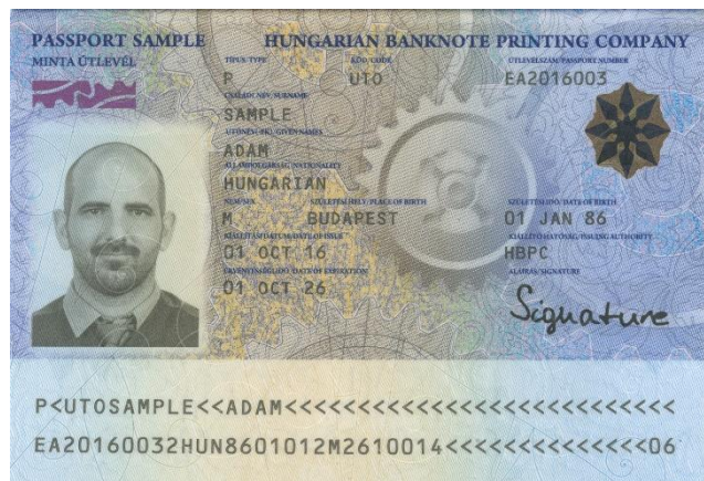
6. kép. Lézergravírozott megszemélyesítésű adatlap
