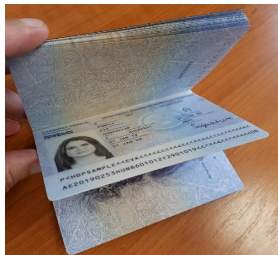
11. kép. Vékony műanyag alapú adatlap lézergravírozással megszemélyesítve
