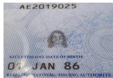
7-9. képek. MLI megszemélyesítési védelmi elem: a megfigyelés szögétől függően egyik, vagy másik kép/adat látható
