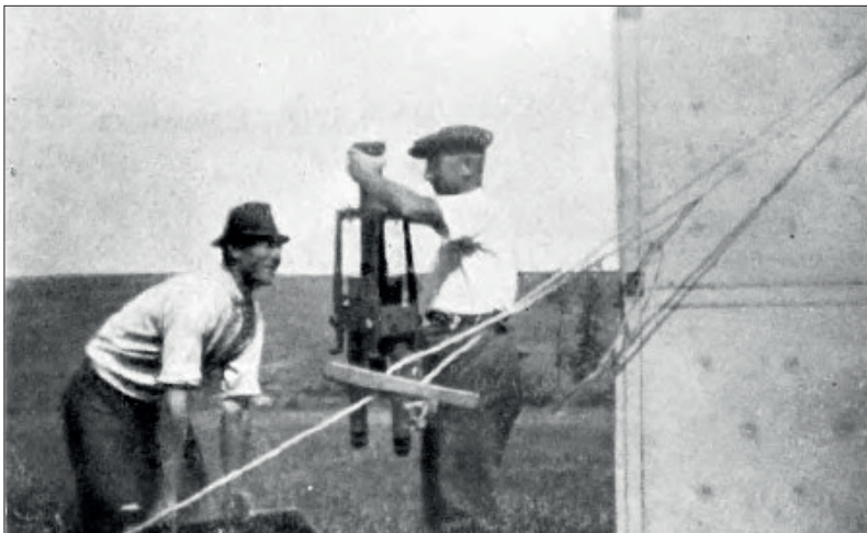
5. ábra: „Eötvös torziós inga a szabadban” A kép készítésének helyszíne ismeretlen (Fekete J. 1939. I. tábla).
