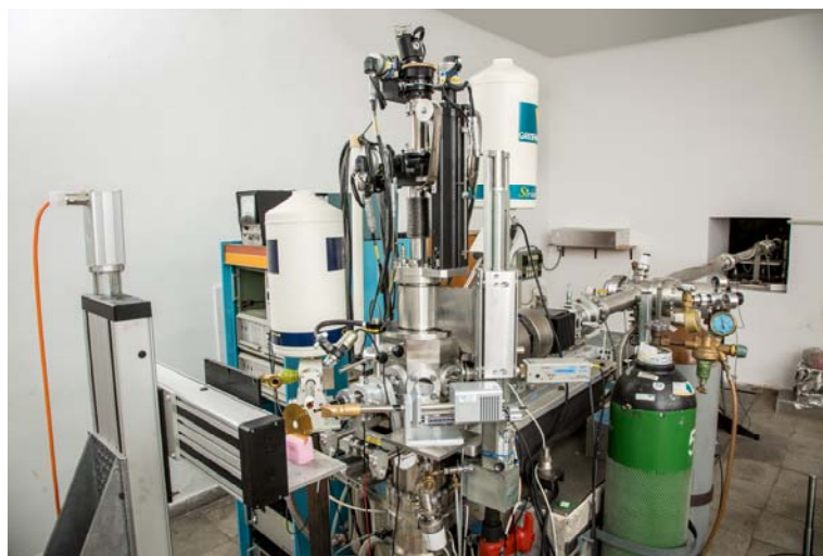
1. ábra: Kihozott mikronyaláb az MTA Atomki Van de Graaff gyorsítójánál
