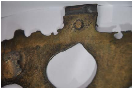
10. ábra: Sorjacepppek és öntési hibák az A-II elem téglalap alakú nyúlványának mindkét oldalán
