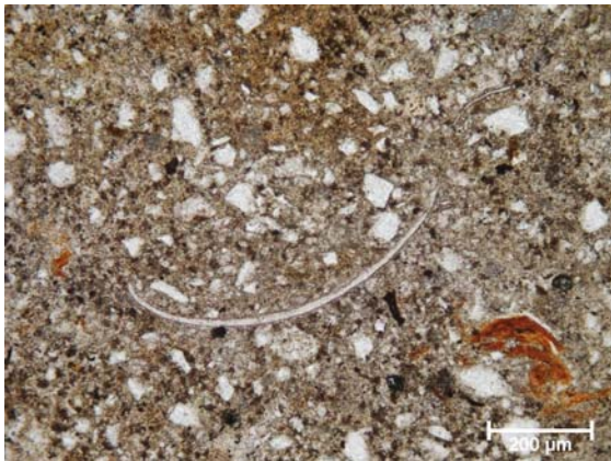
20. ábra: Vékony kagylóhéj flis anyagú recens tengeri iszapban (polarizációs mikroszkópos fénykép, 1N, IST-67 nem égetett, Izola, Észak-Isztria). Képszélesség: 1,2 cm.
